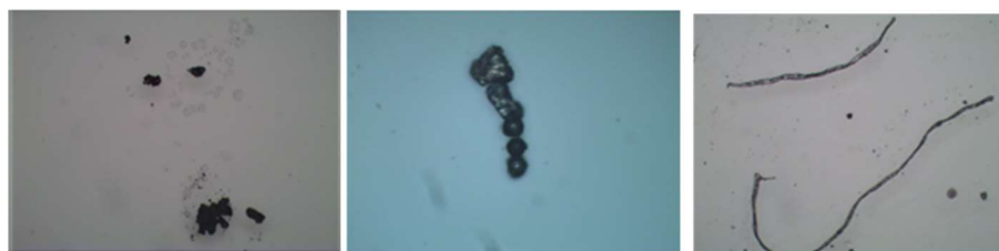
FIGURA 3. Imagens da ferrografia da amostra 52.
