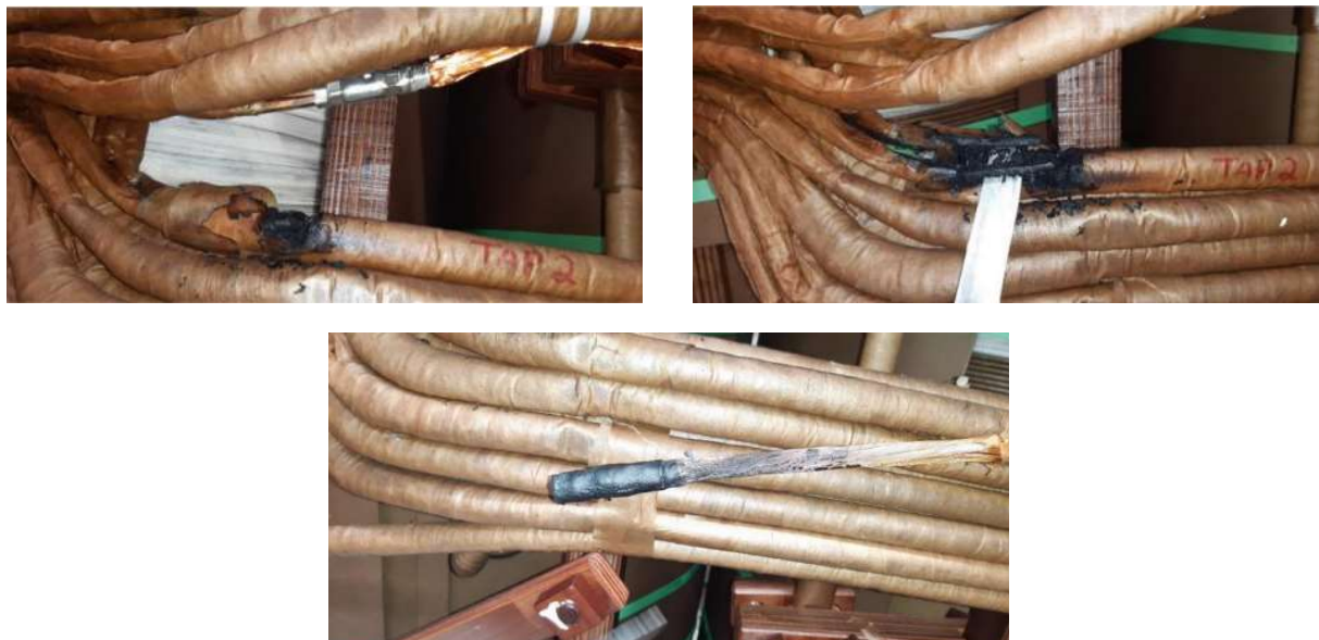
Figura 8: Detalhes da deterioração das luvas de compressão do enrolamento do secundário.
