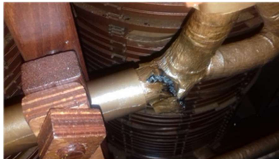
FIGURA 11 – Degradação na conexão Y nos enrolamentos de BT do transformador.
