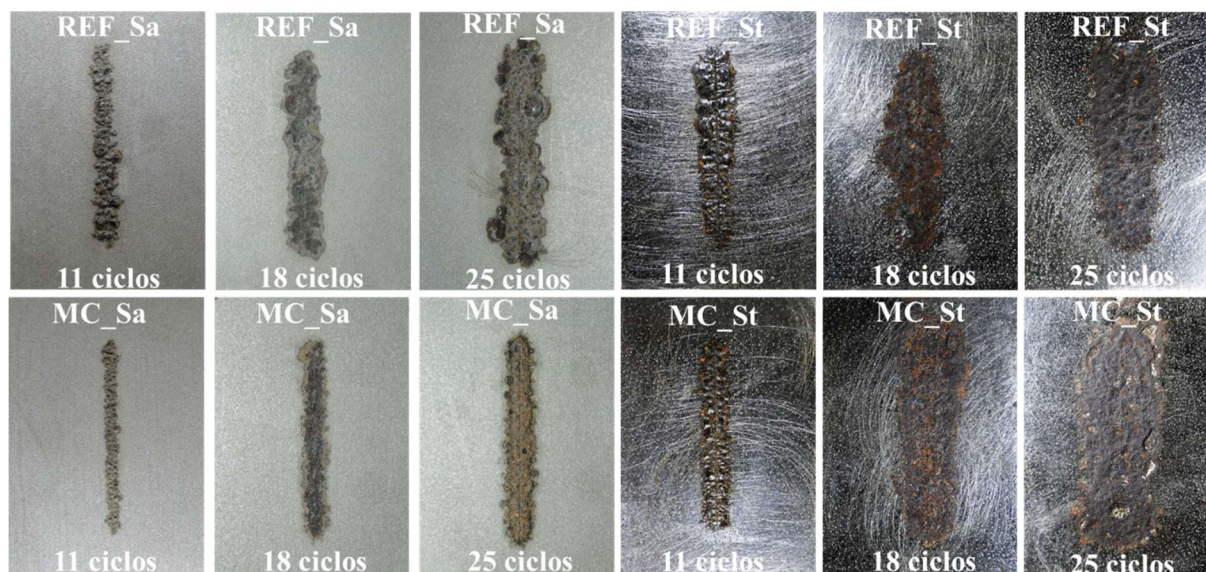
FIGURA 4 – Aspecto visual após remoção de película dos esquemas REF_Sa, REF_St, MC_Sa e MC_St em diferentes tempos de ensaio cíclico de corrosão.
