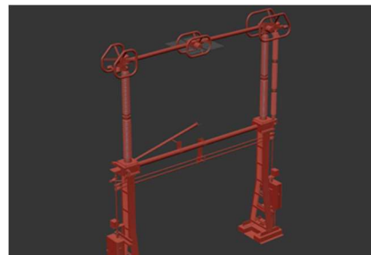
FIGURA 3 - Nuvem de pontos de chaves seccionadoras e o modelo 3D construído
