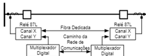
FIGURA 3 - Meios de comunicação do relé 87L usados para teleproteção.
