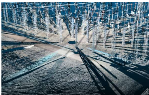
FIGURA 1 - Nuvem de pontos capturada em uma única tomada do scanner na subestação
