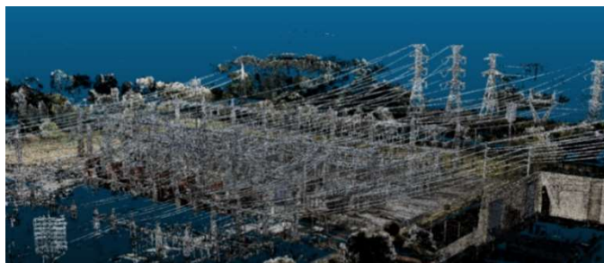
FIGURA 2 - Nuvem de pontos completa, após agregar todas as tomadas do scanner
