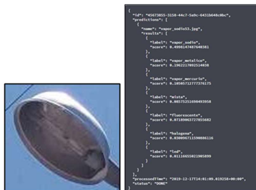
FIGURA 6: Exemplo de Inferência ao modelo de classificação de lâmpadas. Foto: Equatorial
