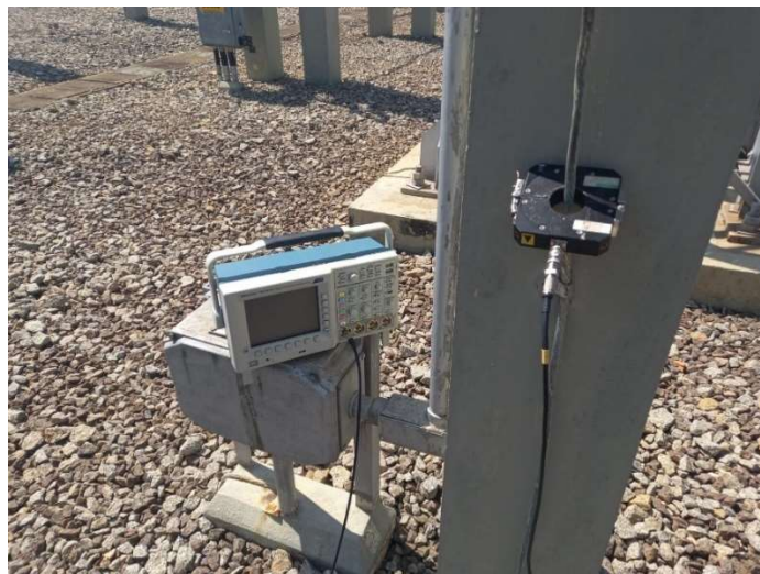
FIGURA 7 - Ensaio de DP pelo método HFCT
