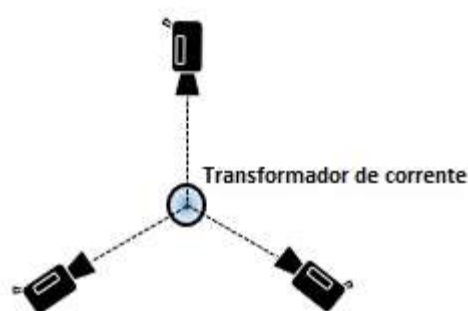
FIGURA 5 – Vista superior do esquema para inspeção circular em TC
