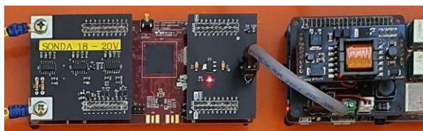
FIGURA – 6 (a) Fotografia da versão final da sonda de potencial.
