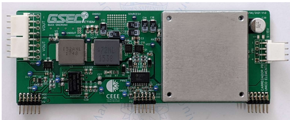
Figura 11 – Conversor abaixador e buck síncrono em bancada
