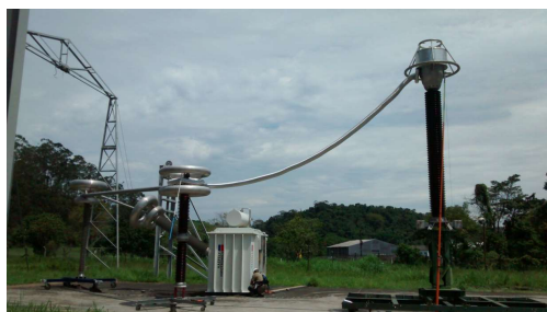
Figura 3 – Detalhe do Equipamento sob teste no Cepel e o Circuito de Medição
