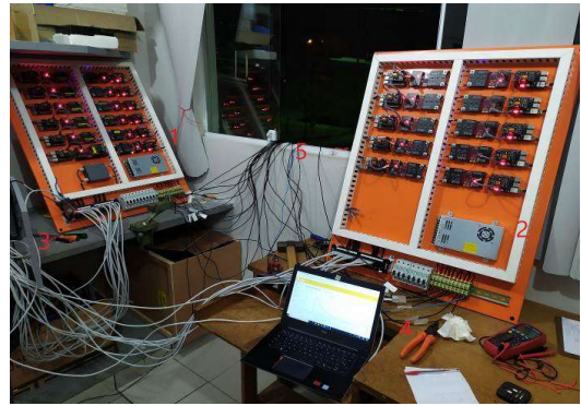
FIGURA 7 – (b) Fotografia demonstrando os testes finais em laboratório e montagem dos painéis com as sondas de medição de potencial e geradores.
