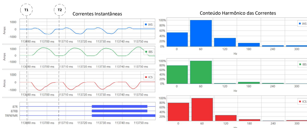
FIGURA 5 –Registro oscilográfico da operação do elemento 87T durante a energização – CEEE-GT
