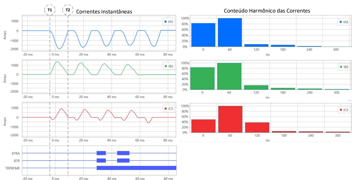
FIGURA 4 –Registro oscilográfico da operação do elemento 87T durante a energização – COPEL-D
