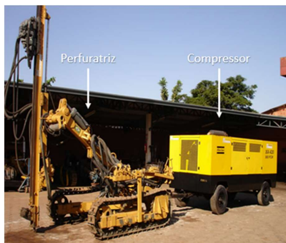
FIGURA 6 – Equipamento utilizado na instalação das ancoragens.
