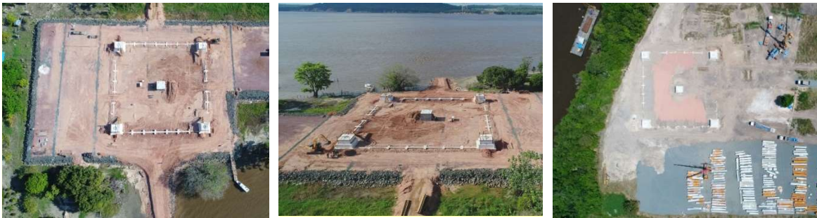
FIGURA 16: Fundações prontas área alagavel e área seca
