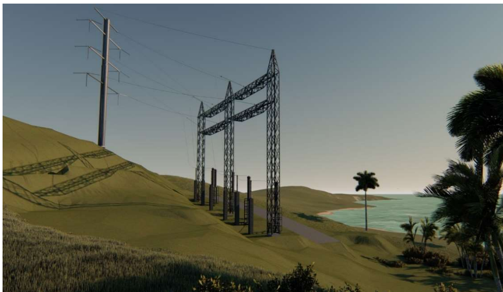
Figura 5: Modelo em 3D dos estudos iniciais da transição aéreo-subaquática (Fasttel Engenharia)
