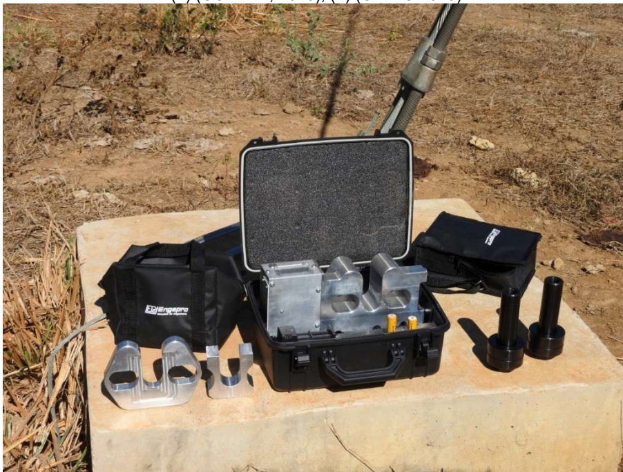
FIGURA 5: Imagem do conjunto básico para o retensionamento (ENGEPRO 2019)
