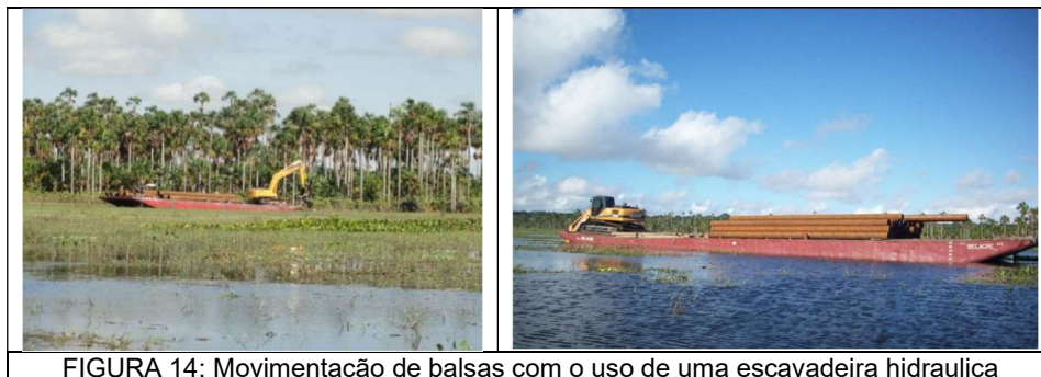
FIGURA 14: Movimentação de balsas com o uso de uma escavadeira hidraulica
