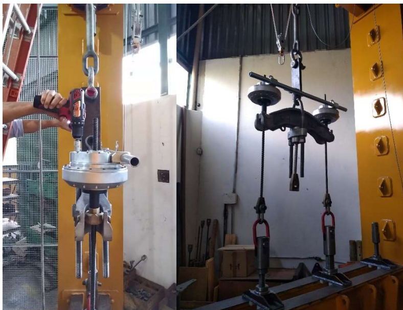
FIGURA 7: Ensaio com carga estática 140 kN (ENGEPRO 2020).
