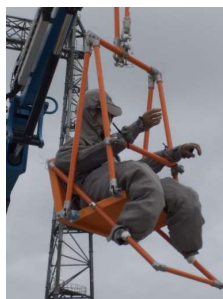
FIGURA 12 – Manequim com roupa condutiva sentado na cadeira isolante
