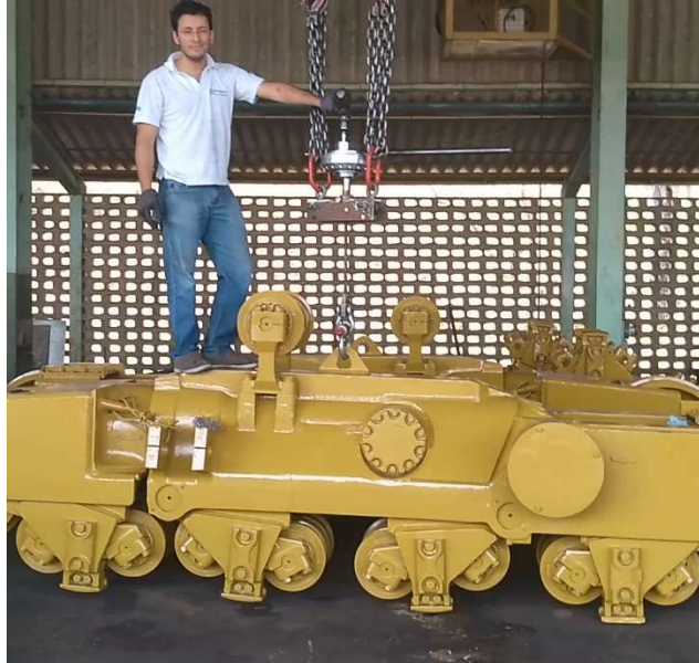
FIGURA 6: Içamento de componente com aproximadamente 70 kN (ENGEPRO 2020).
