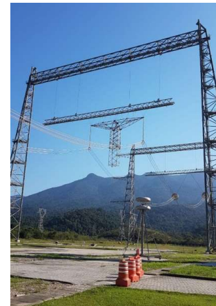
FIGURA 10 – Cabeça de torre estaiada de \pm 800 kV CC montada no LabUAT
