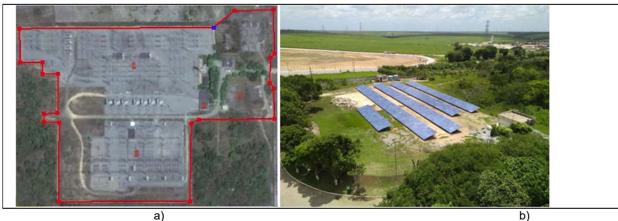
FIGURA 04 – (a) Vista aérea da CHESF/Subestação Messias, com as seguintes identificações: (1) Pátio de equipamentos tensão 500kV; (2) Casa de Comando; (3) Pátio de equipamentos tensão 230kV e (4) área definida para receber a Planta Fotovoltaica 100kW. (b) Planta Fotovoltaica 100kW já instalada, implementada e em plena operação.
