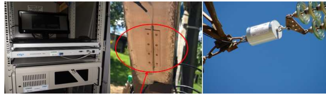
FIGURA 8 - Interrogador de sensores a Grade de Bragg aplicados em uma linha real de 138 kV da Cemig.
