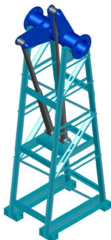
FIGURA 4 – Perspectiva do pilar central com o sistema de pistões hidráulicos
