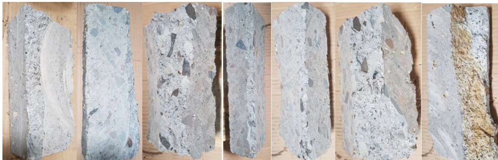
Figura 1. Amostras de concreto envelhecido extraídas da PCH de Passo do Meio, RS.
