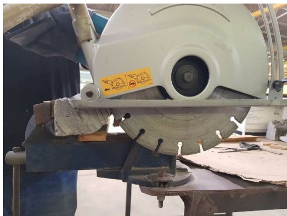
Figura 2. Preparo dos corpos de prova de concreto envelhecido empregando serra mármore circular.
