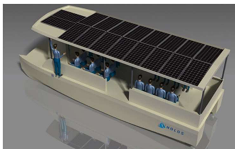
FIGURA 2 - Barco Solar - Propulsão elétrica reduzindo poluição sonora [14]
