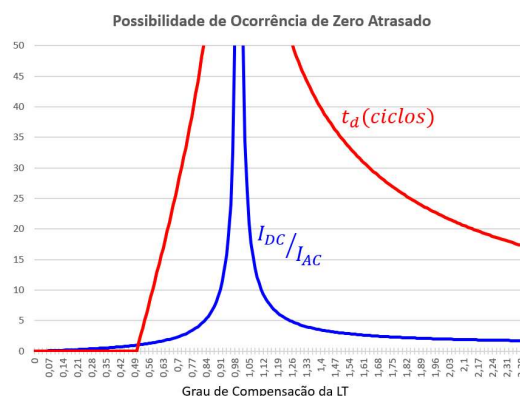
Figura 2 - Possibilidade de Ocorrência de Zero atrasado em função do grau de compensação da Linha de Transmissão
