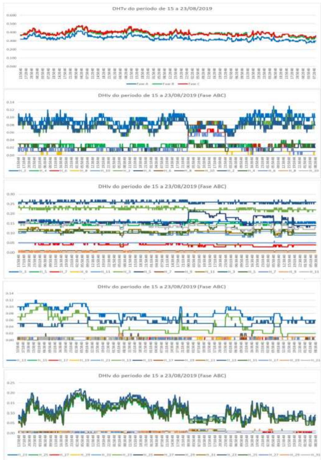
Figura 6 - Medição da distorção harmônica na tensão. Respectivamente: Distorção harmônica total, DHlv para as componentes pares da 2ª a 10ª harmônicas, DHlv para as componentes ímpares da 3ª a 11ª harmônicas, DHlv para as componentes ímpares da 13ª a 21ª harmônicas e DHlv para as harmônicas ímpares da 23ª a 31ª harmônicas
