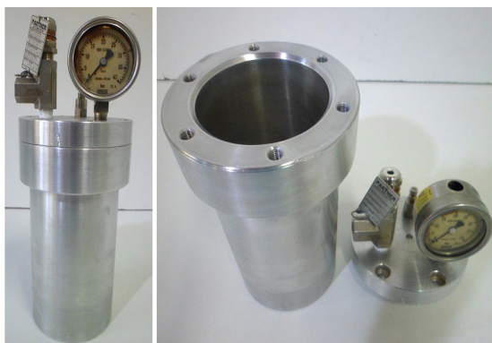
FIGURA 1. Célula de envelhecimento acelerado confeccionada em alumínio equipada com manômetro para controle da pressão e válvula de engate rápido para conexão à bomba de vácuo e aos cilindros de gás.
