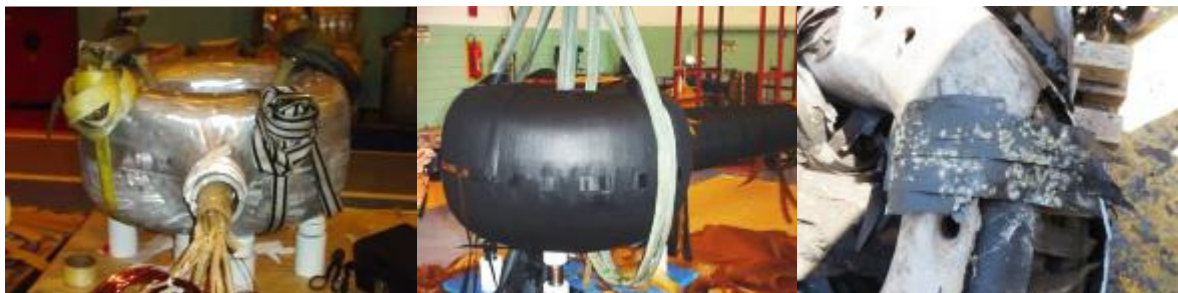
FIGURA 06 (a) Montagem de TC em fábrica - virola (b) Montagem de TC em fábrica, fita semicondutiva enrolada sobre a virola (c) Estado da fita semicondutiva encontrada na desmontagem para análise de falha
