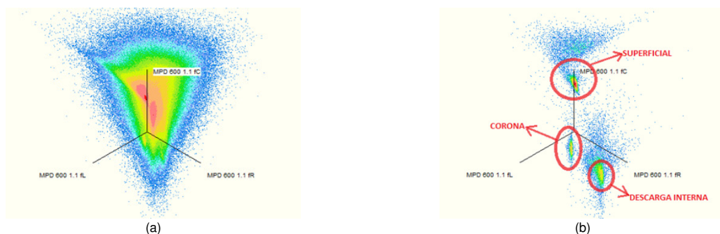
Figura 10 – Etapas de filtragem e separação das fontes de descargas na Fase A.
