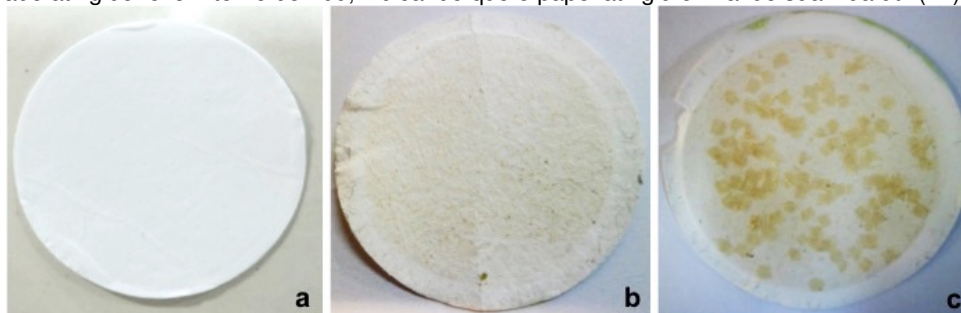
FIGURA 10. Acúmulo de partículas dos papéis isolante não digeridas pela solução de etilenodiamina cúprica e água. Aspecto do a) filtro de fibra de vidro novo, b) após filtragem da solução de digestão da amostra de papel kraft termoestabilizado novo e c) após filtragem da solução de digestão de papel Nomex® 910 novo.
