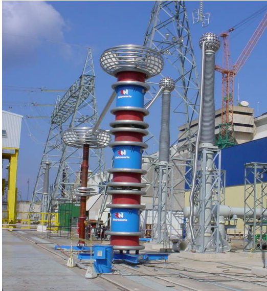
FIGURA 2. Ilustração do equipamento ensaiado, um reator série-ressonante
