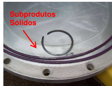
FIGURA 7 - Anel de sustentação do Shield rompido e subprodutos sólidos da decomposição do SF 6
