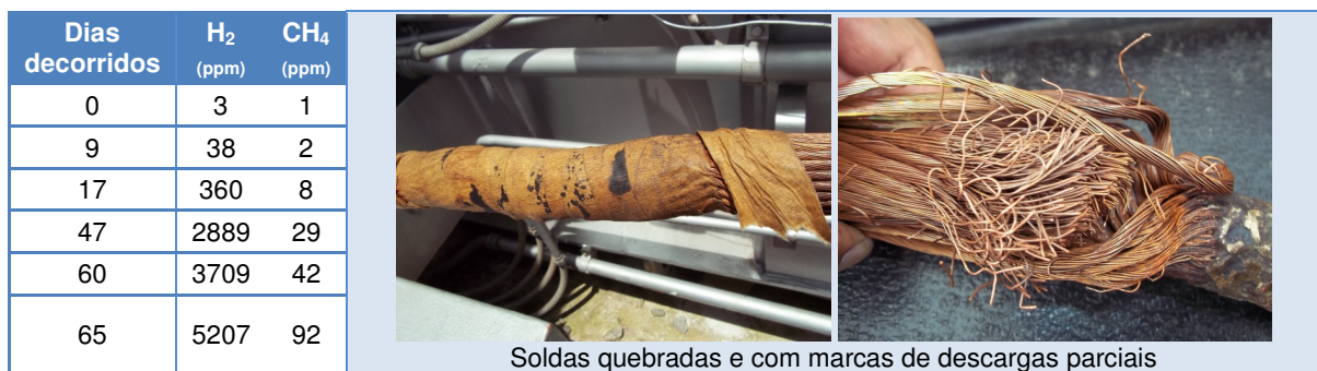
FIGURA 05: (a) Evolução na concentração de gases no autotransformador da CEMIG (b) respectivos defeitos encontrados.
