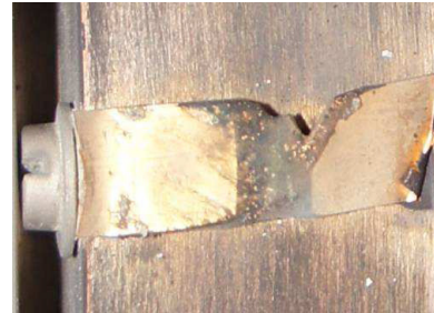
FIGURA 9 - Lâmina de equipotencialização danificada
