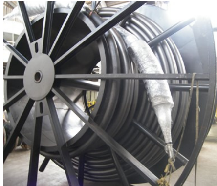
FIGURA 6 – Detalhe do Lance do Protótipo do Cabo (500 metros) com Terminais Enrolado na Bobina
