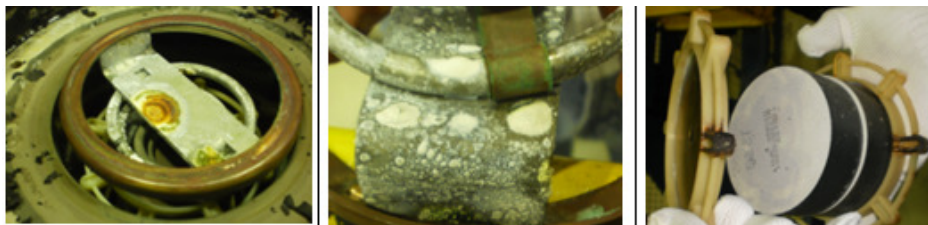
FIGURA 08: Problemas verificados na inspeção interna dos para-raios que apresentaram anomalias na análise termográfica
