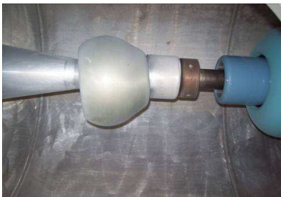
FIGURA 6 - Shield montado de forma desacertada (tocando na barra)
