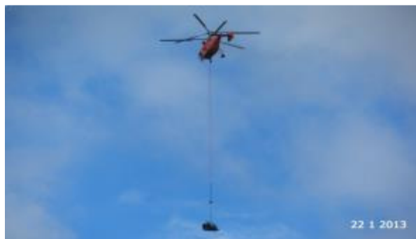
Figura 5 – Transporte de máquinas pesadas por helicóptero
