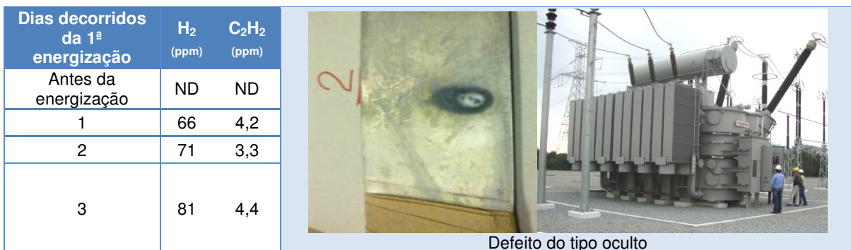
FIGURA 05: (a) Evolução na concentração de gases no autotransformador da CEMIG (b) respectivo defeito encontrado. ND = não detectado
