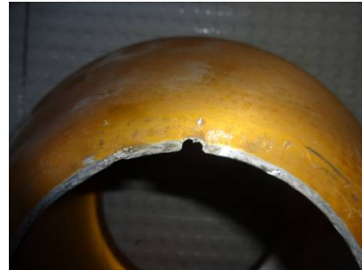
FIGURA 15 - Shield danificado no local do parafuso de fixação
