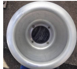
FIGURA 17 - Shield com 4 furos de fixação (melhoria)
