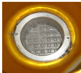
FIGURA 16 - Shield com 2 furos de fixação
