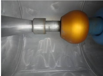
FIGURA 14 - Shield não fixado no suporte da barra da SIG
