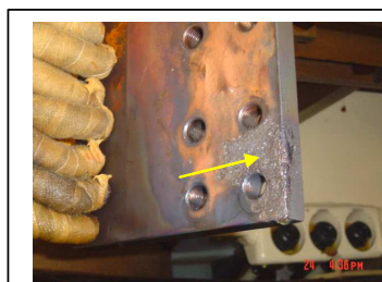
Flanges dos links de interligação apresentando carbonização, corrosão e fusão
