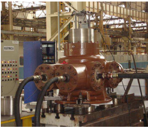
FIGURA 4 – Válvula Distribuidora Modernizada pela ALSTOM em 4 etapas: existente, projeto, ensaio, final
