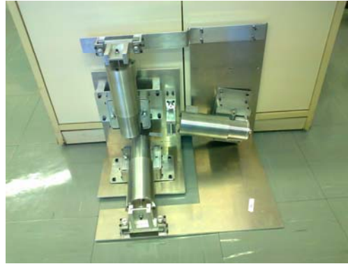
FIGURA 1 – Protótipo do medidor triortogonal de juntas, montado (fev/2011).
