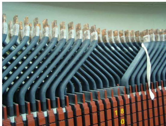
Figura 5 – Barras sendo inseridas no núcleo
