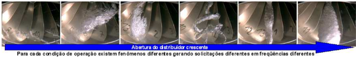
Para cada condição de operação existem fenômenos diferentes gerando solicitações diferentes em frequências diferentes FIGURA 2 – Fenômenos diferentes geram solicitações distintas nos rotores Francis - Visão em abertura crescente
