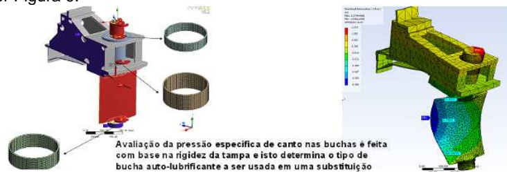
FIGURA 9 – Avaliação da vida útil de buchas requer análise conjunta com tampa.
