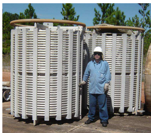
Figura 8 – Filtros de Onda retirados de Operação
