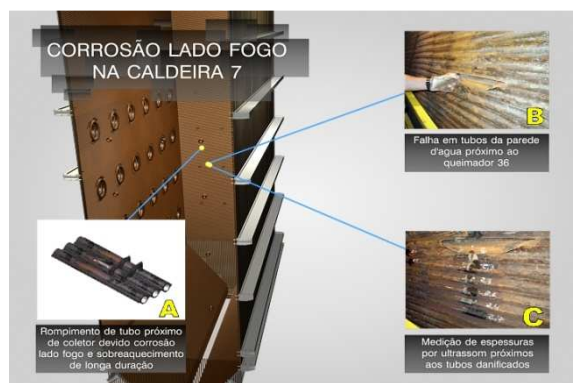
Figura 4: Localização predominante das falhas ocorridas devido Corrosão lado fogo.
