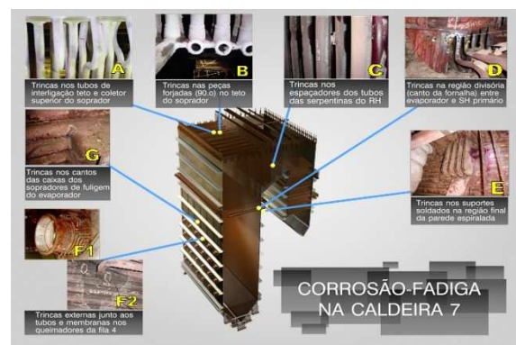
Figura 5: Localização das falhas devido a Corrosão-fadiga
