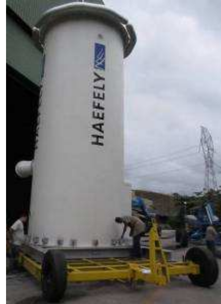
FIGURA 9 - Gerador de impulso de 2,0 MV
