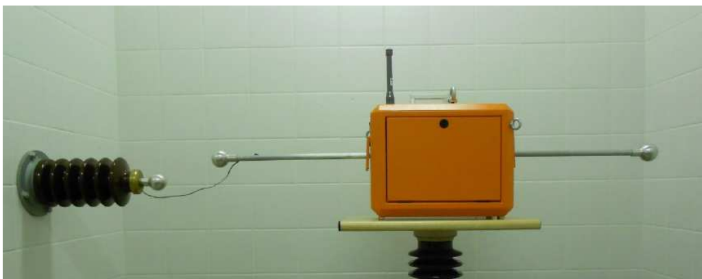
FIGURA 5 - Robô submetido ao ensaio de tensão aplicada no laboratório do CPqD.
