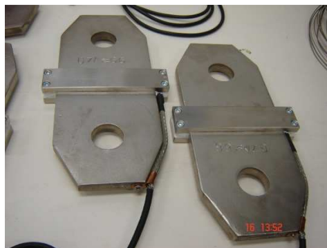
Figura 4 – Aspecto final das células de carga
