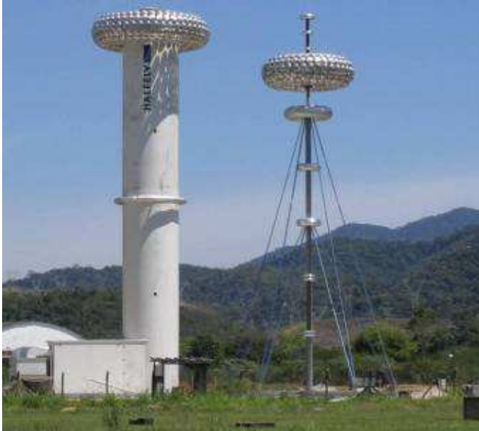
FIGURA 8 – Sistema de impulso de 6,4 MV
