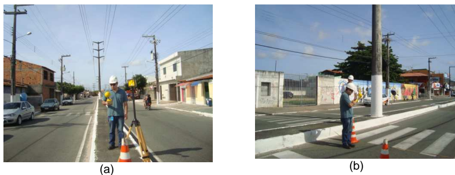
FIGURA 7 – Medição de campo elétrico e magnético em linha Aracaju/Urubu - Jardins/Urubu - ENERGISA. (a) No ponto de mínima distância ao solo. (b) Próximo do suporte
