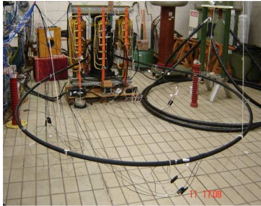
FIGURA 3 - Arranjo experimental para medições de temperatura interna e externa para um cabo Tern revestido com tinta preta fosca de emissividade calculada, \epsilon = 0.90 .
