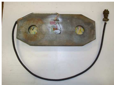
Figura 3 – Célula de carga instrumentada com os strain-gauges
