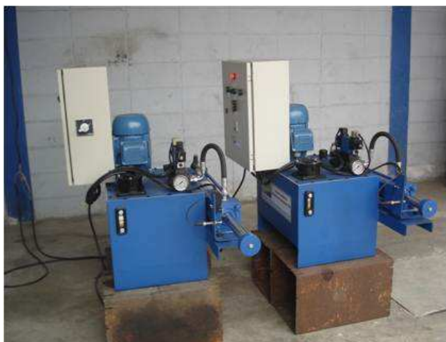
FIGURA 3 – Foto dos pistões operando com o novo óleo durante teste de desempenho.
