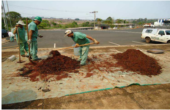
Figura 1 – Preparação do resíduo oleoso para a compostagem nos compartimentos: B1, B2, B3 e B4.
