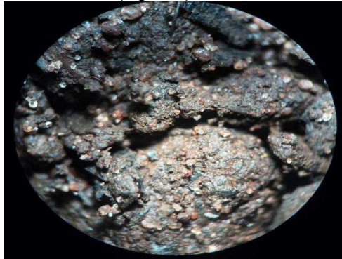
Figura 8 – Macroporos intersticiais observados no material compostado, presentes nas baías: B1, B2 e B3.
