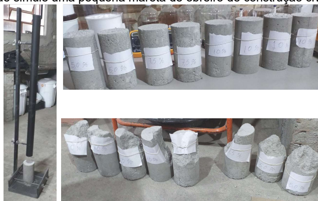
FIGURA 2 – Ensaio de Friabilidade – CP íntegros e CP testados
