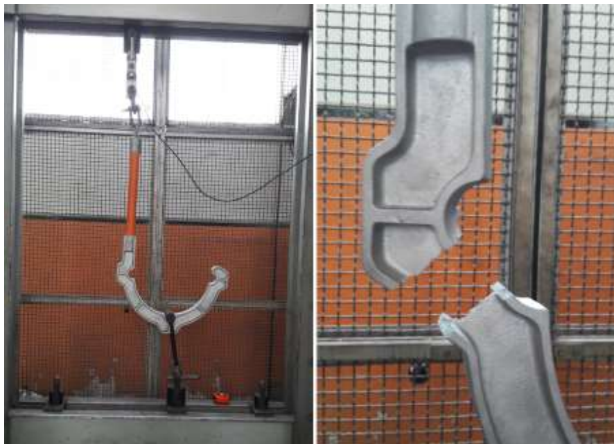
Figura 4 - Ensaio mecânico para validação do projeto
