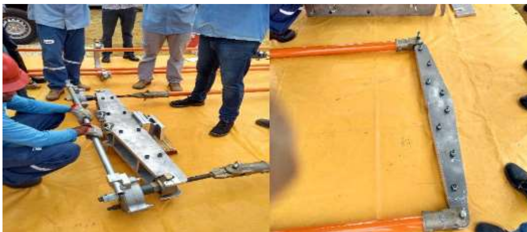
Figura 6 - Jugos lado energizado e lado desenergizado – Treinamento em solo
