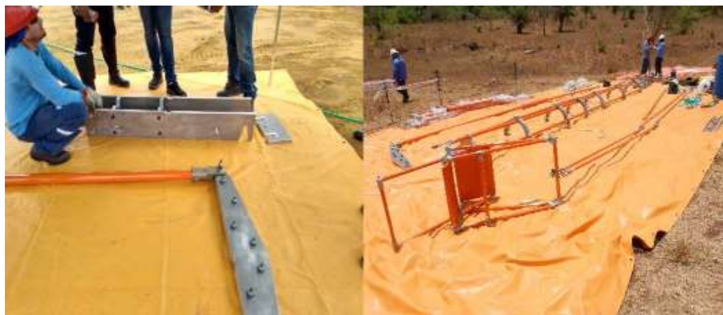
Figura 7 - Jugo tipo caixote lado energizado e cadeira de acesso ao potencial – Treinamento em solo
