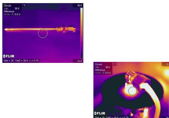
FIGURA 3 – Sondas de Laboratório – Inspeção com Infra Vermelho
