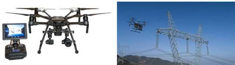
FIGURA 8 – Drone homologado na Elektro e imagem durante a inspeção
