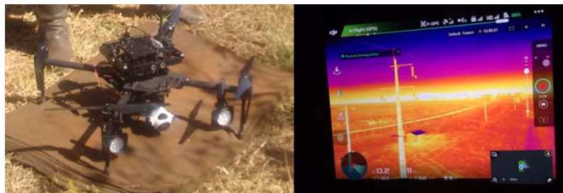
FIGURA 7 – Drone com lanternas e Imagem térmica noturna
